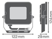
**Scheda tecnica Ledvance Proiettore LED Compatto Bianca 20W 2000lm 100D - 865 Luce del Giorno | IP65 - Simmetrico**
